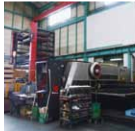
◀板金への穴あけやレーザー加工を1台で行う複合機
